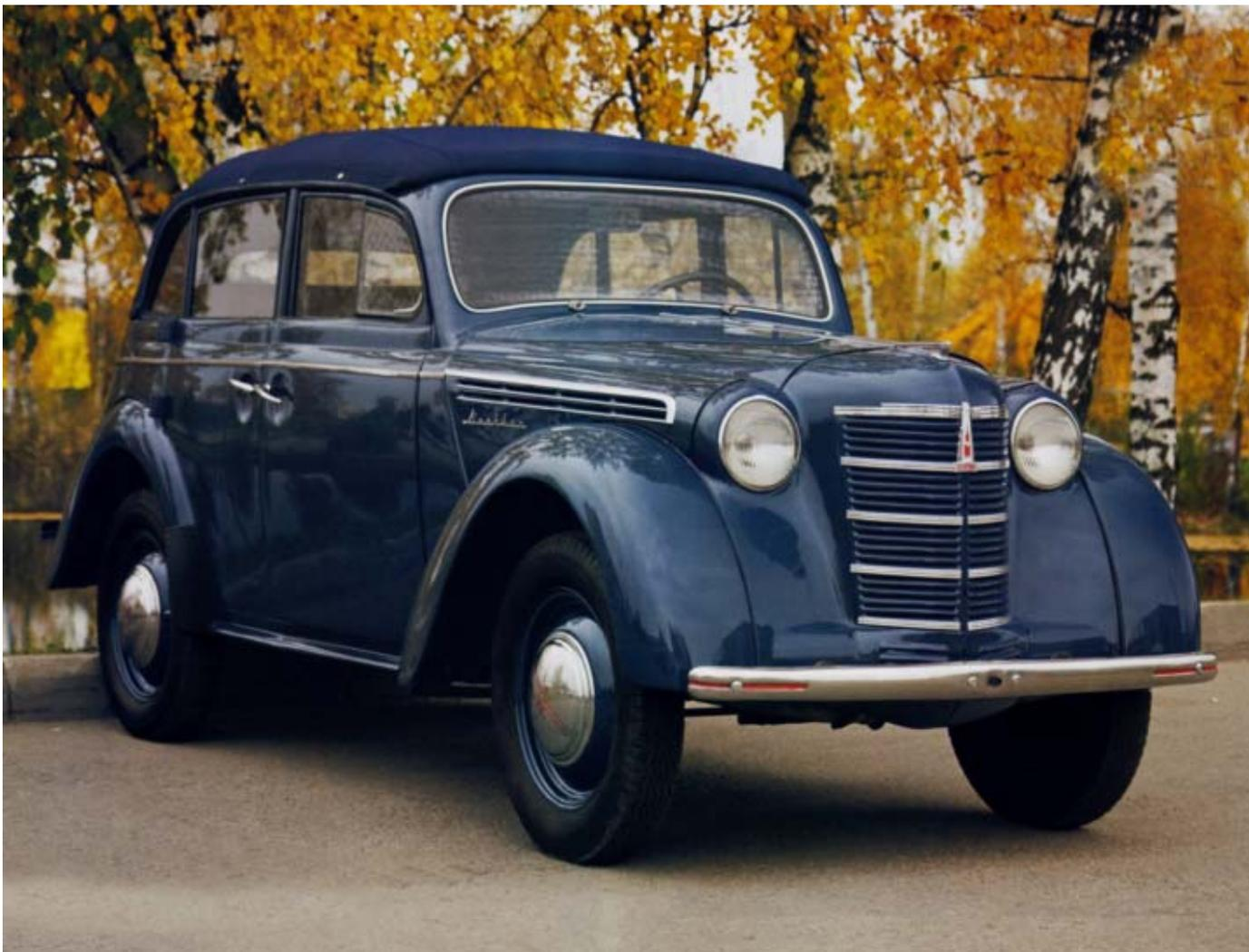
Машинка имела крайне примитивный нижнеклапанный моторчик объемом 933 кубика, который был удешевлен настолько что отсутствовала даже водяная помпа, а охлаждающая жидкость циркулировала самотеком. Правда, сконструировать надежную и неприхотливую помпу в то время было не так просто. Не было подходящих материалов, а то что было, работало плохо. Например, инструкция Москвича-401 рекомендует смазывать этот узел каждые 100 (сто!!!) километров.
