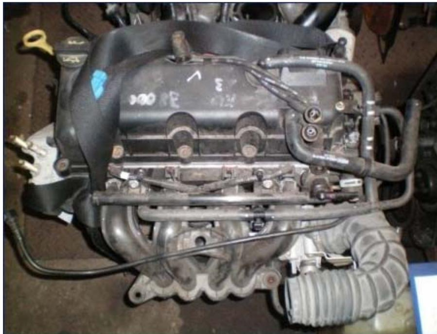
Кроме того двигатель продолжает выпускаться для промышленных целей и в качестве стационарного (модификации VSG-411 и VSG-413). Также он используется для погрузчиков и небольших судов. Причем, судя по фотографиям, в его основе карбюраторная Валенсия, с начала выпуска которой прошло уже 40 лет.
