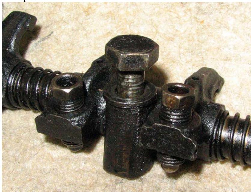
Кстати, экономные англичане почти весь двигатель сделали из чугуна (блок, головка, коллектор) и при этом он получился даже легче (порядка 120 кг в версии с объемом 1.3 литра) чем двигатель 408-го Москвича (140 кг при объеме 1.36 литра), в котором широко использовались алюминиевые сплавы. Кроме того, в чугуне не закисают болты, не срываются резьбы и его не ведет от перегрева.
